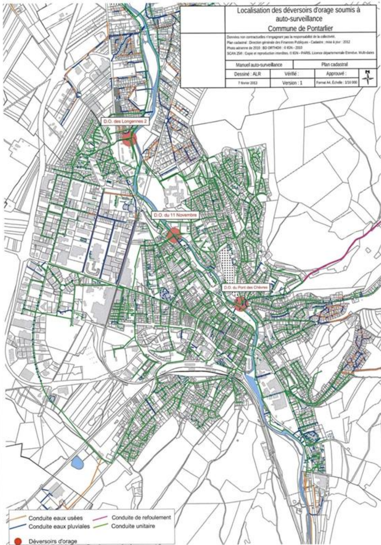
Localisation des 3 DO soumis à autosurveillance
