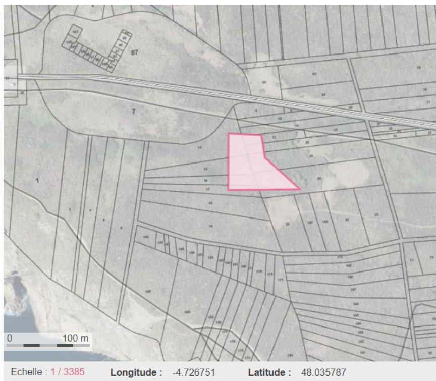
Illustration 6 : Vectorisation d'un SIS dont l'emprise ne correspond pas au parcellaire actuel sur l'outil de saisie des SIS (SIS en consultation).
