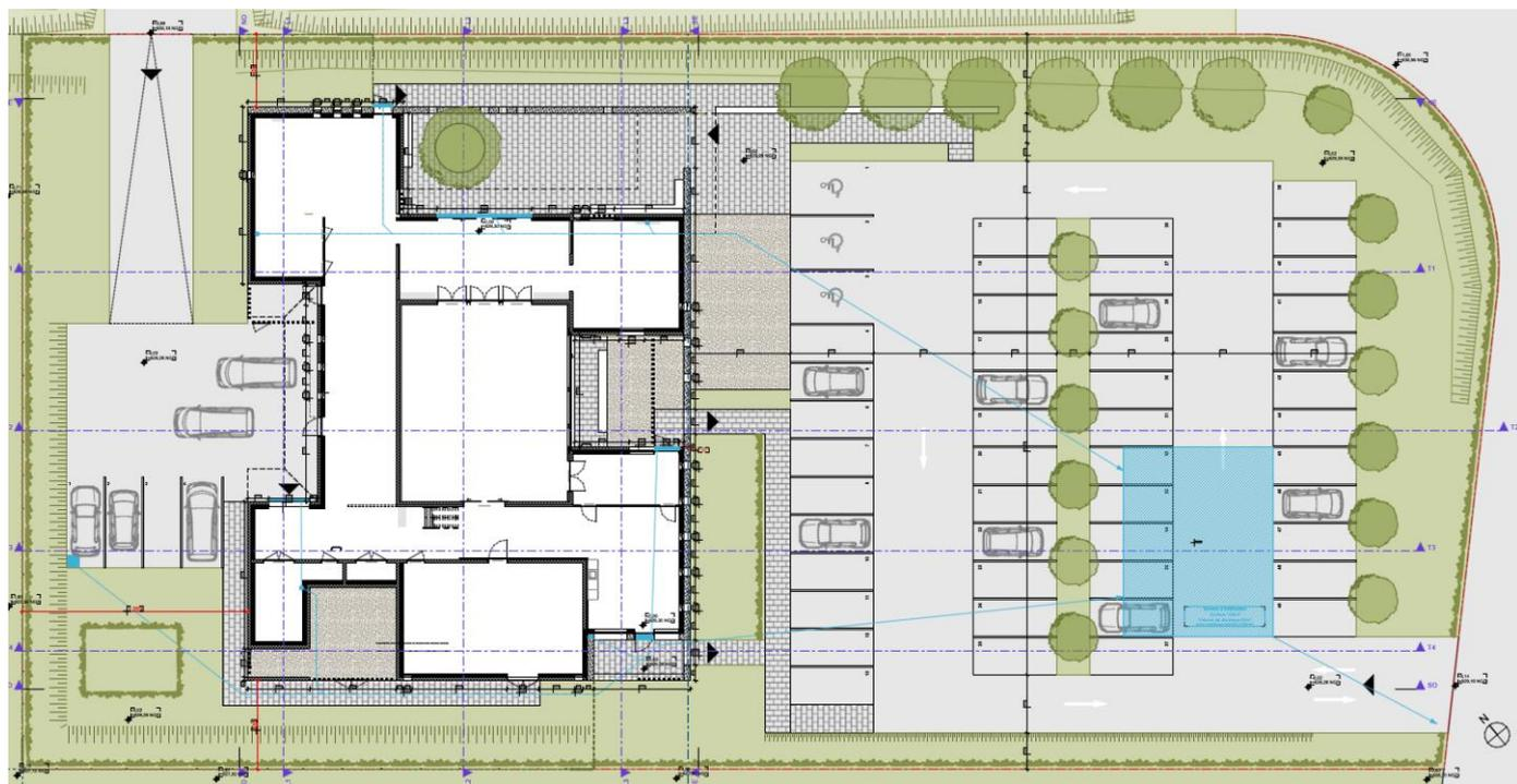
Les eaux pluviales du bâtiment et des espaces extérieurs imperméables et semi-imperméables seront collectées et acheminées dans un ouvrage d'infiltration sous voirie, situé dans la zone du terrain où la perméabilité est la plus forte, de l'ordre de  $5 \cdot 10^{-5}$ .
